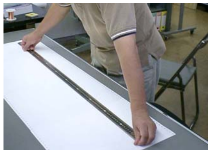
図 3.3: 銅線の長さの測定
