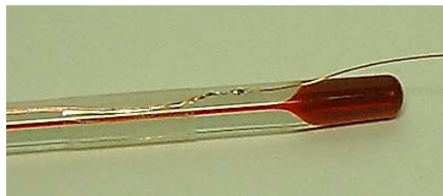
図 3.4: 銅線を温度計に固定
